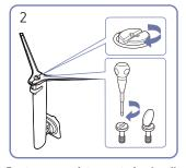
Ruotare completamente la vite di collegamento posta sul fondo del piedistallo in modo da fissarlo saldamente.
