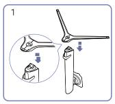
Inserire la base del piedistallo nel connettore seguendo la direzione indicata nella figura. Verificare che il connettore del piedistallo sia saldamente fissato.
