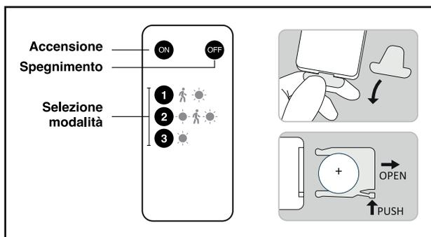
Al primo utilizzo rimuovere la linguetta di protezione della batteria. Per l'inserimento e/o sostituzione delle batterie si raccomanda di rispettare la polarità.
