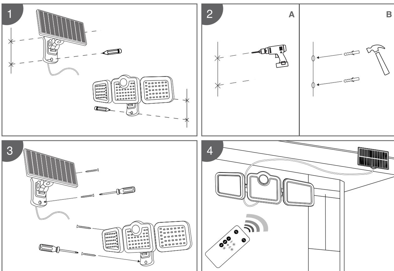
Installare il pannello solare in un luogo direttamente esposto ai raggi solari, in modo che possa ricevere luce solare diretta per almeno 6 ore al giorno.
